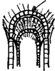
Surge de la sucesión de arcos de medio punto que se apoyan en dos líneas paralelas o lo que es lo mismo, la yuxtaposición de arcos de medio en lo largo de un eje longitudinal. Garvita o descansa sobre la totalidad de los muros en que se apoya. El muro no es sólo cerramiento del edificio, sino que se convierte en el apoyo fundamental, por eso los muros son gruesos, no muy altos y con pocas aberturas para que pueda resistir sin volcarse por el gran peso y empuje de la pesada bóveda de piedra.
